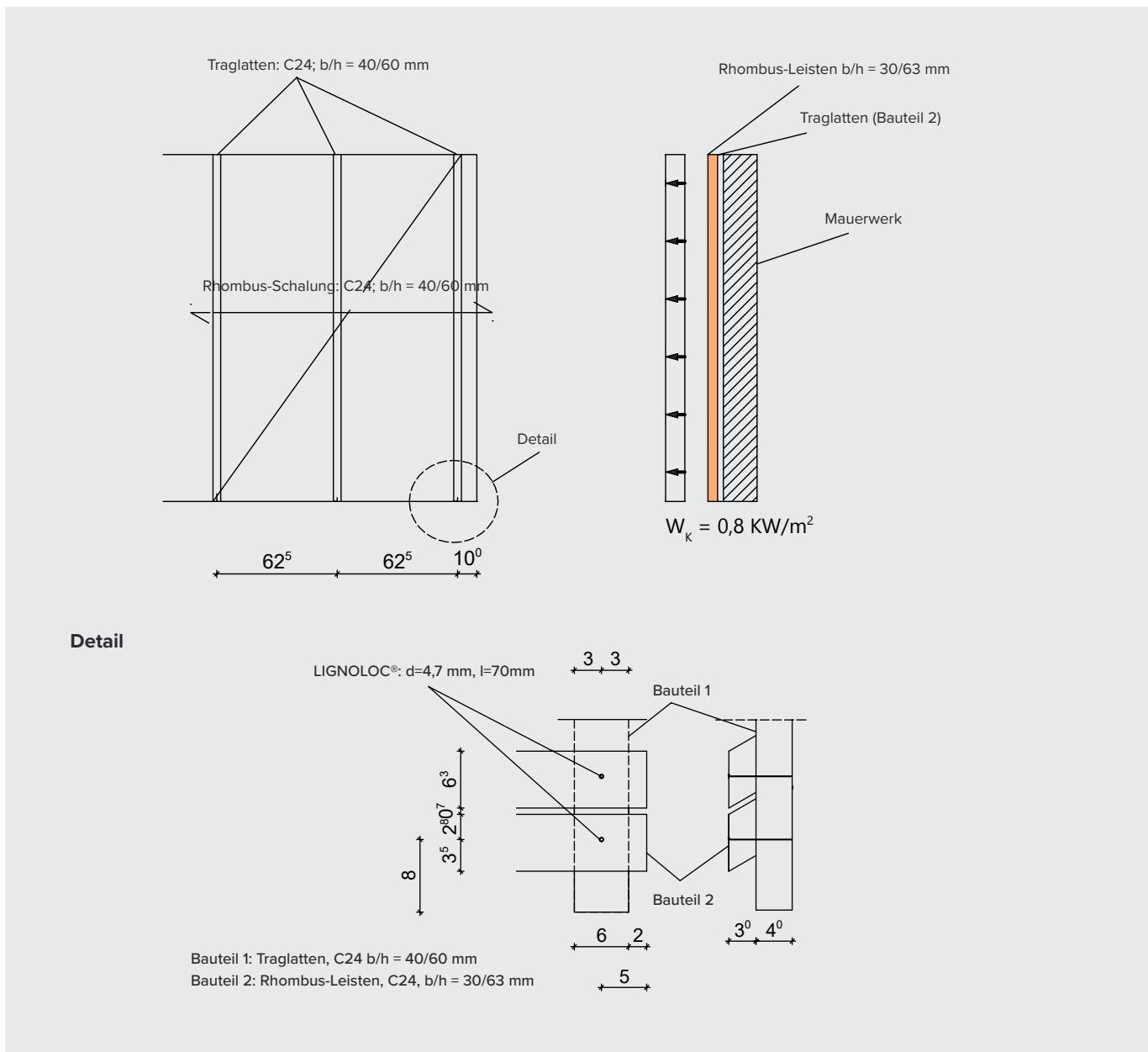
Eine Betrachtung am Gesamtgebäude hat eine maßgebende charakteristische Windsogeneinwirkung von  $0,8 \text{ kN/m}^2$  ergeben. Für die Rhombus-Leisten kann von einer mittleren Wichte von  $\rho_{mean, Holz} = 4,2 \text{ kN/m}^2$  ausgegangen werden.
