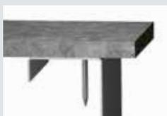
Die **SCRAIL® STEELTHREAD STRUCTURAL** wird wie ein magaziniertes Nagel mit einem pneumatischen Schussgerät durch OSB, Sperrholz oder Massivholz in Blech eingeschossen.
